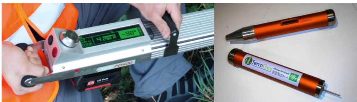
Figure 1. Résistographe IML PD-400 (à gauche) correspondant au modèle acquis dans le cadre du projet ; et Pilodyn (à droite), avec l'unité inférieure sans la protection et montrant l'aiguille de pénétration.
